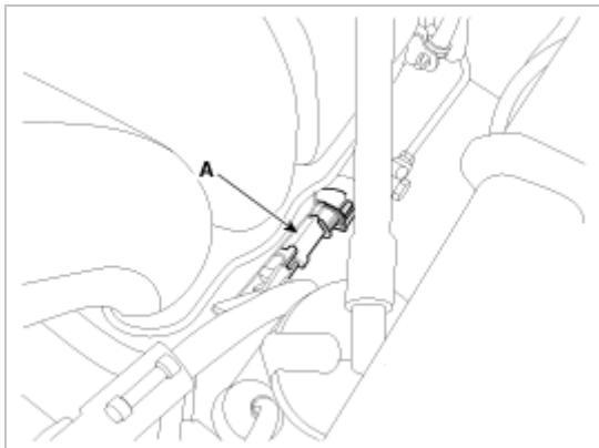
3. 拧下固定螺栓(A)，从气缸体上拆卸传感器。
